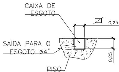
DETALHE DA CAIXA DE ESGOTO
