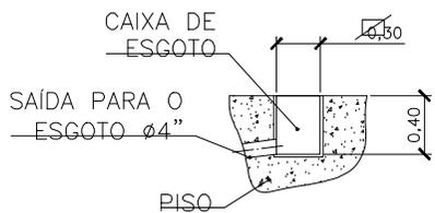
DETALHE DA CAIXA DE ESGOTO
